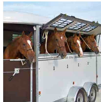
APERTURA ESTIVA: Tettuccio laterale che permette l'accesso alle teste dei cavalli. Optional.
