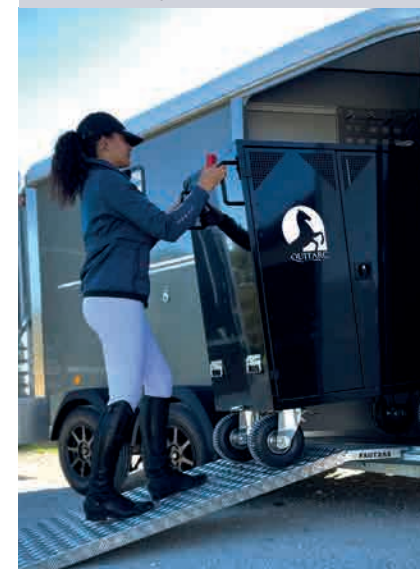
RAMPE E VERRICELLO ELETTRICO per il sollevamento di un grande baule da competizione. Optional.
