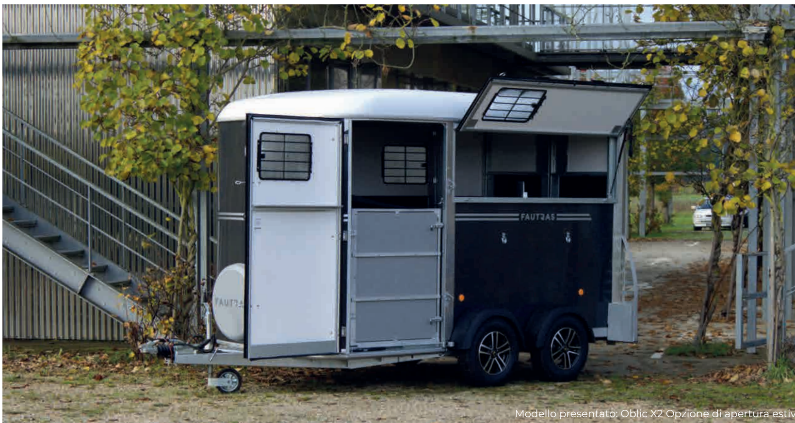
APERTURA FAUTRAS: 2 porte posteriori che canalizzano i cavalli per un facile imbarco. L'apertura senza rampa evita di doversi abbassare e offre la possibilità di arretrare davanti al box.
