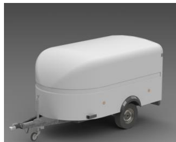
Carrosserie polyester monocoque aérodynamique
