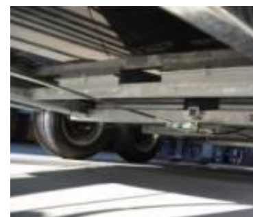
Frein à inertie et suspensions à roues indépendantes sans entretien pour une excellente tenue de route.
