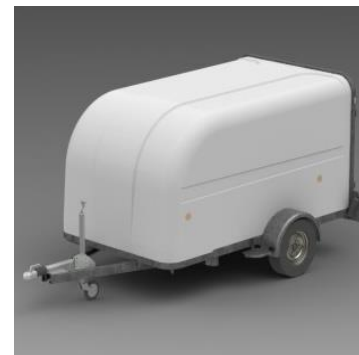
Carrosserie polyester monocoque aérodynamique
