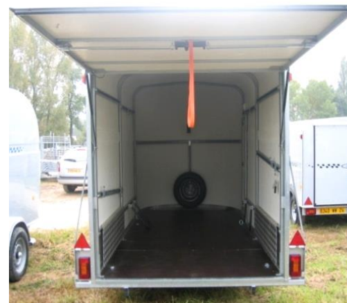
Ouverture totale auvent avec vérins compensateurs
