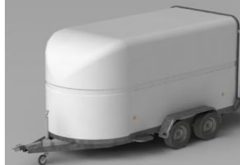
Carrosserie polyester monocoque aérodynamique
