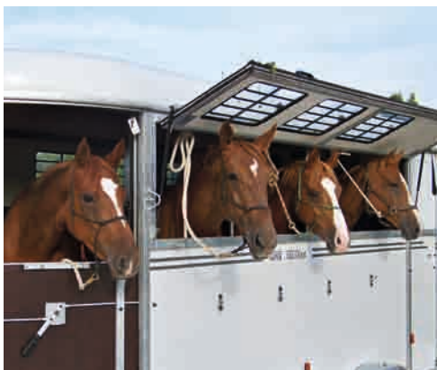
Ouverture latérale pour plus d'aération à l'arrêt.
