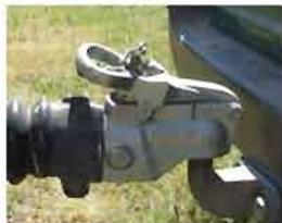
**⚠ ATTENTION** : Pour le modèle de tête d'attelage avec barillet sur le côté, pour être bien attelé, la poignée doit être à l'horizontale et le curseur (si celle-ci en comporte un) doit se situer au milieu sur la partie verte avec le signe « + ».
