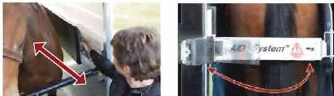
Remarque : L'Aid System permet une ouverture et fermeture du portillon depuis l'avant (avec une poignée située à l'avant contre la paroi intérieure du van) mais aussi depuis l'arrière (à l'aide d'une targette à ressort prévu à cet effet).
