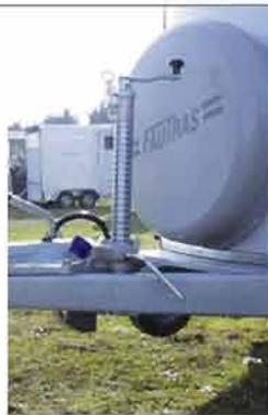
⑦ Accrocher le câble de sécurité sur le point fixe prévu sur l'attelage de la voiture (ce point fixe doit être dans l'axe du câble). L'utilisation de ce câble est obligatoire car il permet de stopper la remorque en cas de mauvais attelage de la remorque.
