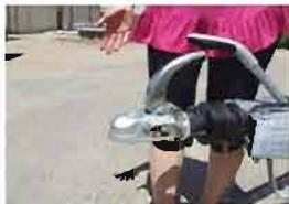
2 - Tirer le loquet situé sous la tête de lapin vers l'avant d'une main et avec l'autre main, tirer la poignée vers le haut et basculer la poignée vers l'arrière.
