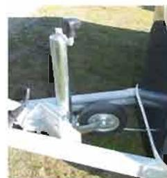
• Roue jockey non automatique sur les modèles de la gamme Transport diagonal (Oblic, Promax 3 et 4, Victorious et Olympus) composée d'une tige verticale (appelée fût) qui passe dans un guide situé sur la partie attèle de la remorque).
